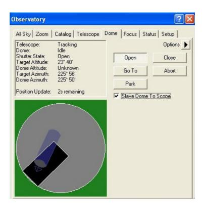
Рисунок 2 – Пример синхронизированного положения телескопа и купола (вид сверху)
