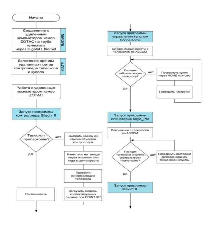
Рисунок 1a 1б – Блок-схема системы управления «Цейсс-1000»
