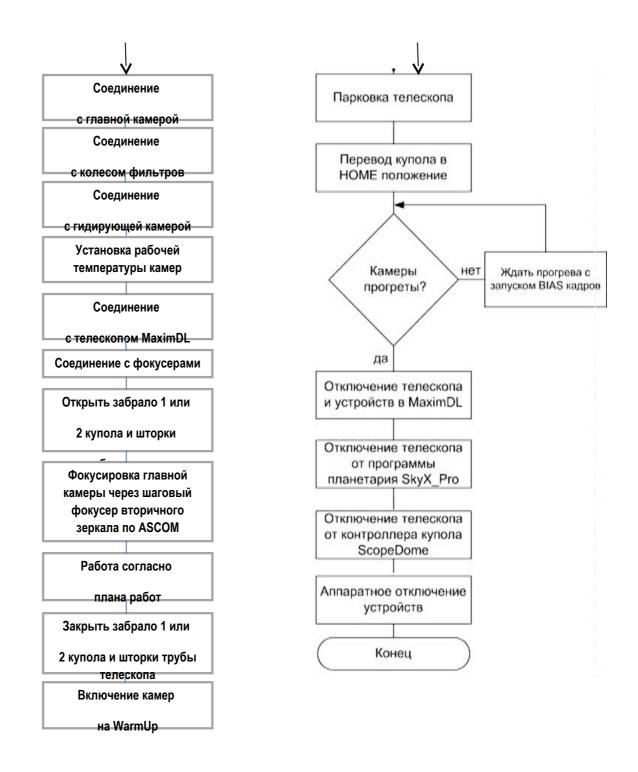
Рисунок1в и 1г – Блок-схема системы управления «Цейсс-1000»
